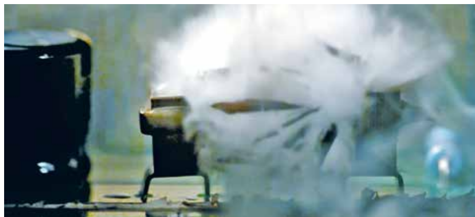
Hochgeschwindigkeitsaufnahme: Im Moment, während die Ampulle aufspringt und die Flüssigkeit freisetzt, verdampft diese und löscht den entstehenden Brand.
